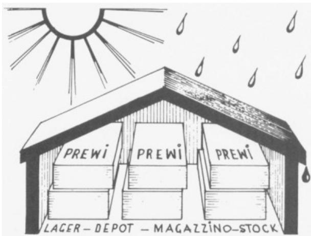
3. Wichtig: Auf den Baustellen müssen die Matrizen dennoch unter Dach gelagert werden, damit nicht durch Sonne und Regen die Trennfilme oder -folien beschädigt werden.
